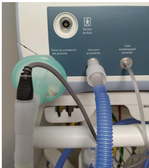
Figura 5. Filtros en rama espiratoria de ventiladores mecánicos
